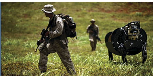
Εικόνα X: Πειραματικό στρατιωτικό σύστημα του Σώματος Πεζοναυτών των ΗΠΑ, για τη μεταφορά βαριών φορτίων σε δύσβατα εδάφη (Πηγή: https://www.dvidshub.net/image/1445811/meeting-ls3-marines-experiment-with-military-robotics )
